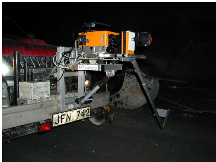
Laserscannern med servomotorfäste och prisma
