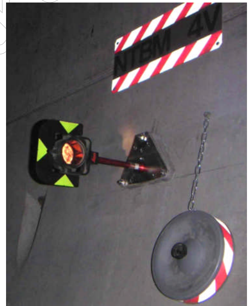
Bakobjekt med mätarm typ Leica standard.
